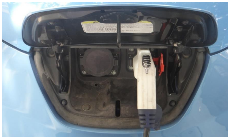
Figura 23 - Recarga Modo 2 no Nissan Leaf (Elaboração Própria)
