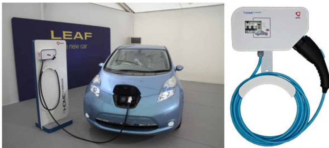
Figura 19 – Estação de recarga usando corrente alternada [46]
