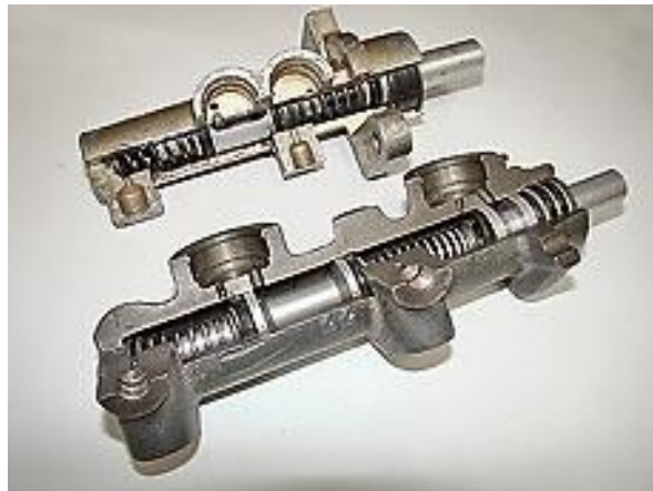
Figura 24: Cilindro Mestre do Sistema ABS [27]
