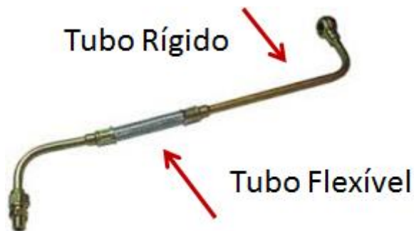
Figura 32: Duto Flexível e Rígido de Freio [25]
