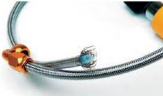
Figura 31: Duto Flexível de Freio de nylon com trama de aço externa [25]
