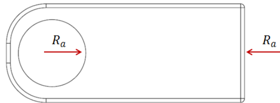
Figura 49: Diagrama de Corpo Livre da Junta Rotacional
