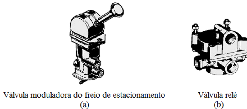
Figura 4: Válvula moduladora do freio de estacionamento, (a) Válvula relé, (b) [23]
