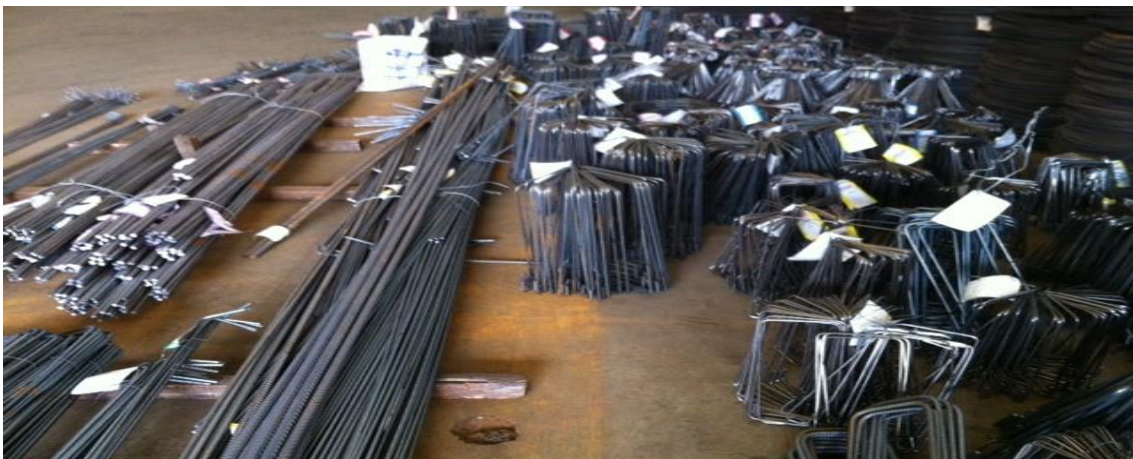
Figura 14 - Armadura pré-fabricada (Fonte: araguaiaferro).
